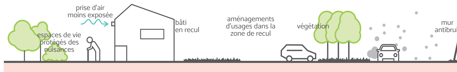
▲ Aménager en bordure de route avec nuisances
